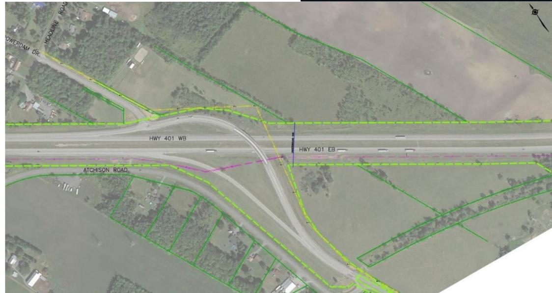
Solution 1 : Ne rien faire implique le remplacement de l'échangeur existant par un nouvel échangeur sur l'emplacement existant avec la configuration actuelle. Cette option n'implique aucune modification provisoire à l'échangeur pour améliorer la configuration de la route ou intégrer de futures options d'échangeur.
